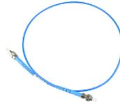
保偏型单模单芯光纤跳线，保偏专用可调散件，FC/PC-FC/PC，Nufern/Coherent PM780-HP 保偏单模光纤， $\phi 3.0\text{mm}$  蓝色 PVC 松套管，0.5米
