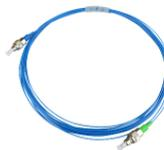
保偏型混合转接单模单芯跳线，保偏专用可调散件，FC/PC-FC/APC，Nufern/Coherent PM780-HP 保偏单模光纤， $\phi 0.9\text{mm}$  蓝色 Hytel 松套管，3米
