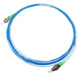
保偏型单模单芯光纤跳线，保偏专用可调散件，FC/APC-FC/APC，Nufern/Coherent PM780-HP 保偏单模光纤， $\phi 0.9\text{mm}$  蓝色 Hytel 松套管，3米
